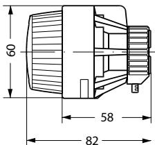
RA 2920 (модель с защитным кожухом)
